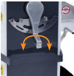
Abbassando l'estremità sinistra della leva manuale, il tappeto si muove verso destra. Abbassando l'estremità destra della leva manuale, il tappeto si muove verso sinistra. Posizionando la leva manuale in posizione orizzontale, la macchina si arresta. Durante il funzionamento, la leva manuale non torna automaticamente in posizione orizzontale.
