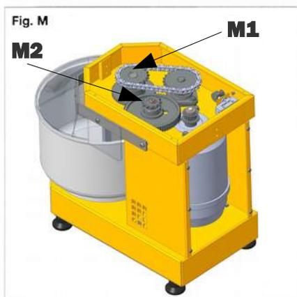
allentare le quattro viti che bloccano il supporto della coclea, (Fig. M2), spingere lo stesso in avanti fino ad assicurarsi che la catena sia sufficientemente tesa infine fissare le viti (Fig. M1).
